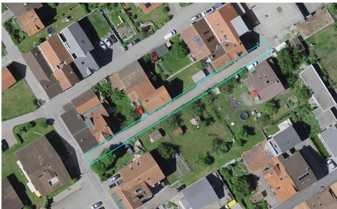
Bei der gesamtheitlichen Oberflächensanierung ist vorgesehen, den bestehenden, aufgerissenen und löcherigen Belag samt Oberbau zu entfernen und eine neue Kofferung mit Roh- und Feinplanie aufzubauen. Mit dem Versetzen von Schalensteinen einreihig und zweireihig als Wasserstein, dem Einbau von Strassensammler und mit einem 80 mm starken Asphaltbelag soll die Strassenoberfläche künftig und «Stand der Technik» entwässert werden.
